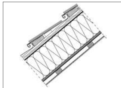
A „QUICK STEP® - RHEINZINK®-lépcsős fedés” szerkezeti felépítése
